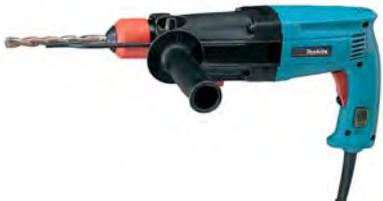
Три режима работы: сверление, сверление с ударом и долбление. Расцепляющая муфта предотвращает рывок при заклинивании бура. Электронная регулировка числа оборотов для точного сверления + реверс. Усовершенствованный ударный механизм для снижения вибрации при работе инструмента
