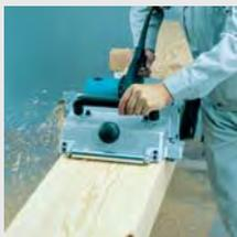
Отличный инструмент для выполнения объёмных работ. Ширина строгания - до 312 мм за один проход.
