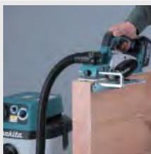
Удобная регулировка глубины строгания с градацией выбора 0.1 мм. При каждом шаге изменения глубины строгания на 0.1 мм слышен и чувствуется щелчок что позволяет точно регулировать глубину строгания. На подошве имеется подножка, что предотвращает повреждение ножа и защищает заготовку от царапин даже
