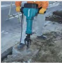
Высокая мощность для тяжёлых условий работы. Рукоятки с виброгашением. Возможность использования стандартных долот (28,6 мм). Система автоматического отключения щёток.
