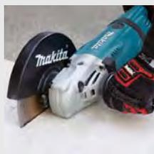
редуктора на 90 градусов. Опорная шайба "Суперфланец" облегчает демонтаж диска после работы.
