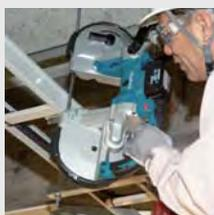
Лёгкий, хорошо сбалансированный инструмент. Электронный ограничитель тока для защиты от перегрузки (с сигнальным светодиодом). Подсветка рабочей области. Регулировка скорости с помощью электронного регулятора оборотов позволяет подобрать скорость полотна необходимую для конкретного материала. Эргономичная обрезиненная рукоятка, фронтальная
