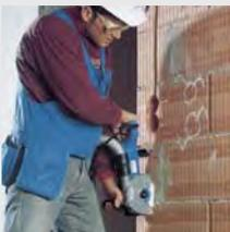
Мощность мотора 1800 Вт и высокая режущая способность (от 7 до 35 мм по ширине и от 7 до 45 мм по глубине) идеальный для работ под разводку электропроводки и водосточных систем, а также систем отопления.
