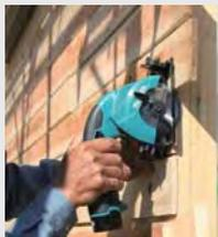
Лёгкий и компактный инструмент, длина всего 300 мм. Мощный двигатель при большом числе оборотов (1,400 мин<sup>-1</sup>) обеспечивает гладкий и быстрый распил. Функция обдува линии реза увеличивает точность распила заготовки. Обрезиненная рукоятка, покрытая противоскользящим эластомером, обеспечивает
