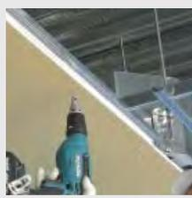
Высокая производительность, благодаря большому моменту затяжки. Легкий и компактный инструмент. Новый мотор с 4-мя магнитами обеспечивает высокую мощность. Эргономичная рукоятка. Подсветка рабочей области. 16 положений установки крутящего момента. 3-режима работы, включая режим сверления с ударом. 3 скорости вращения. Быстрозажимной патрон.
