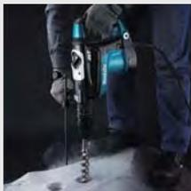
Два режима работы: сверление с ударом или долбление. Самая мощная и эффективная модель в своём классе с низким уровнем вибрации. Анти-вибрационная технология AVT и антивибрационная рукоятка уменьшает вибрацию и нагрузку на пользователя во время работы, увеличивая комфорт работы и производительность. Световой индикатор напоминает о необходимости замены угольных щёток. Индикатор неисправности кабеля и включателя.
