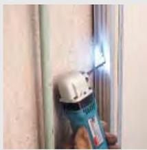
Компактная и легкая угловая дрель. Высота головной части инструмента всего 79 мм. Выключатель оснащен роликом регулировки скорости, что позволяет начать работу с определенного уровня оборотов двигателя. Возможна установка боковой рукоятки.
