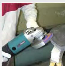
Предназначена для работ с бетоном и очень твёрдым камнем. Идеальна для шлифовальных работ. Специальная система привода с муфтой (Super Joint System™) предотвращает рывки инструмента при работе и пуске. Лабиринтное уплотнение защищает мотор и подшипники от загрязнения. Установка защитного кожуха, без специального инструмента.
