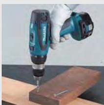
Двигатель с бронзово-графитными щётками, заменяемыми снаружи. Возможность установки 16 ступеней крутящего момента. Две скорости сверления. Тормоз двигателя для сложных работ по закручиванию. Планетарная передача с малым трением. Разборный двигатель делает возможной замену ротора при ремонте для уменьшения времени и затрат.
