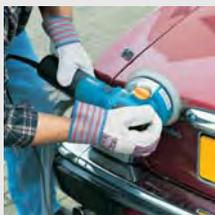
Универсальное применение (грубая шлифовка, финишная шлифовка и полировка) благодаря вращательному и вибрационному режимам и электронному контролю скорости. Эффективная система пылеудаления через шлифовальную пластину. Регулировка скорости для различных областей применения.
