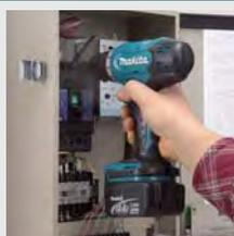
Легкий и компактный инструмент. 16 положений установки крутящего момента. Обрезиненный эргономичный корпус. Быстрозажимной патрон для быстрой и удобной замены биты. Дополнительный аккумулятор в комплекте поставки.
