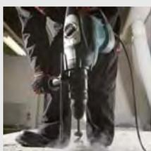
Два режима работы: сверление с ударом или долбление. На 30% больше скорость бурения и на 5% снижены затраты на обслуживание, чем у HR5001C. Возможность выбора удобного для работы выключателя: курковый – для сверления или ползунковый – для режима отбойного молотка.
