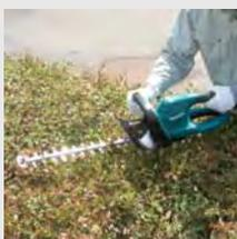
Удобная обрезиненная эргономичная ручка. Три выключателя встроены в заднюю, переднюю и нижнюю ручки. Инструмент включится только тогда, когда нажаты любые два из этих выключателей. Специальная направляющая предотвращает отскакивание инструмента. Специальное покрытие лезвий увеличивает их износостойкость и прочность.
