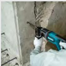
Три режима работы: сверление, сверление с ударом и долбление. Отсутствие удара на холостом ходу. 40 положений установочки бура. Эргономичная и обрезиненная задняя D-образная рукоятка, обеспечивает максимальный контроль над инструментом. Высокая износостойкость инструмента.
