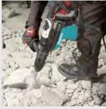
Два режима работы: сверление с ударом или долбление. Антивибрационная технология AVT уменьшает вибрацию и нагрузку на пользователя во время работы, увеличивая комфорт работы и производительность. Возможность выбора удобного для работы выключателя: курковый – для сверления или ползунковый – для режима отбойного молотка. Световой индикатор напоминает о необходимости замены угольных щёток. Индикатор неисправности кабеля и выключателя.
