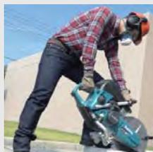
Мощный 4-х тактный двигатель. Пружину для гашения вибрации. Легкий запуск благодаря системе автоматической декомпрессии и совмещенно выключателю дросселя и праймера. Ролики для удобства перемещения.
