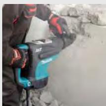
Два режима работы: сверление с ударом или долбление. На 30% больше скорость бурения и на 5% снижены затраты на обслуживание, чем у HR5001C. Антивибрационная технология AVT и антивибрационная рукоятка уменьшает вибрацию и нагрузку на пользователя во время работы, увеличивая комфорт работы и производительность. Световой индикатор напоминает о необходимости замены угольных щёток. Индикатор неисправности кабеля и включателя. 16 положений установки угла бора.
