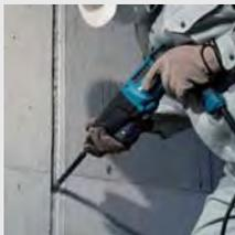
Три режима работы: сверление, сверление с ударом и долбление. Отсутствие удара на холостом ходу. Высокая износостойкость инструмента. Переключатель режимов работы находится в нижней части корпуса, что снижает вероятность его повреждения.
