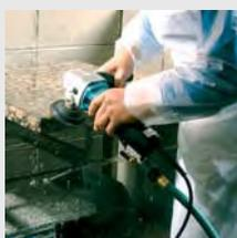
Идеально для эффективной полировки камня. Регулятор скорости для установки оптимального режима работы. Равномерная подача воды, защищает шлифовальный диск от перегрева и забивания пылью. Удобная эргономическая рукоятка. Регулятор подачи воды расположен под рукой.
