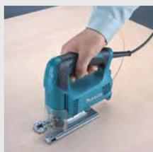
Механическая система противовеса для снижения уровня вибрации. Снижает утомляемость оператора и повышает производительность. Эргономичный дизайн и обрезиненная рукоятка обеспечивает больший контроль над инструментом. Подвижный прозрачный защитный кожух позволяет визуально следить за линией реза при работе, и оберегает оператора от попадания стружки и пыли.
