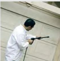
Мойка высокого давления оснащается надёжным насосом, что обеспечивает надёжную и продолжительную работу в тяжёлых условиях. Регулируемое сопло имеет переключатель давления струи и вида распыления (низкое/высокое, точечное/веерное).
