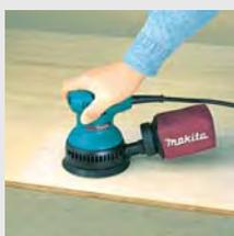
Гладкая и ровная шлифовка. Быстросменные абразивные листы (на липучке). Легкий корпус с эргономичной рукояткой, удобный для работы одной рукой, обеспечивает полный контроль над инструментом. Эффективная система пылеудаления через шлифовальную пластину.
