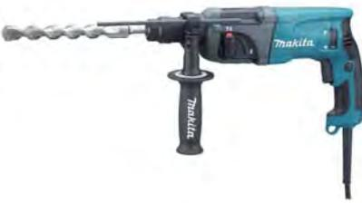
Два режима работы: сверление, сверление с ударом. Угольные щётки защищены от пыли и строительного мусора. Срок службы угольных щёток в 2,7 раза дольше чем у предыдущих моделей. Также скорость и вращающий момент двигателя при обратном вращении. Более лёгкое и быстрое обслуживание благодаря упрощённой конструкции шесточного узла. Большой сальник предотвращает утечку смазки между корпусом двигателя и корпусом редуктора.
