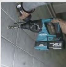
Три режима работы: сверление, сверление с ударом, долбление. Перфоратором удобно работать благодаря идеально подобранному центру тяжести, расположенному вблизи ручки. Противоскользкая обрезиненная боковая рукоятка. Быстрая смена инструмента.
