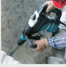
Два режима работы: сверление с ударом или долбление. Плавный пуск. Световой индикатор напоминает о необходимости замены угольных щёток. Индикатор неисправности кабеля и выключателя.
