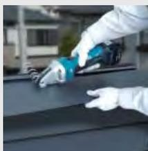
Большой контроль и маневренность при работе достигается за счет легкости и компактности. Минимальный внешний диаметр реза 30 мм как влево, так и вправо без острых углов и заусенцев. Защита от непредвиденного включения со световым индикатором. Световой индикатор предупреждает о низком заряде батареи. В инструменте предусмотрено место для хранения шестигранного ключа.
