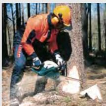
Идеально подходит для распиловки дров, брёвен, обрезке веток. Инерционный тормоз цепи. Автоматическая система смазки цепи. Конструкция инструмента обеспечивает защиту от вибраций. Быстрый старт. Электронное зажигание.
