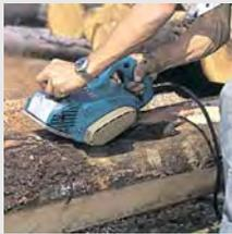
Специальная конструкция разработана для обработки вогнутых поверхностей. Высокая скорость вращения вала с лезвиями обеспечивает идеальную чистоту обработки поверхности материала.
