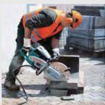
Увеличенный воздушный фильтр и новая система воздушной фильтрации эффективно защищает двигатель от проникновения пыли и грязи. Улучшенное охлаждение двигателя. Плавная регулировка направляющей с ручкой. Карбюратор с диафрагмой, электронное зажигание, механический стартер.
