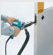
Длина опоры шлифовальной ленты 110 мм. Направляющая поворачивается на 100° для шлифования в труднодоступных местах. Электронная регулировка скорости. Простая настройка положения шлиф. ленты с помощью поворотной ручки. Специальная система пылеудаления МАКПА. Дополнительные направляющие (6 мм и 13 мм) для широкого спектра работ по шлифовке и зачистке.
