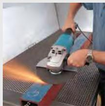
Надёжный и пылезащитный 2000 Вт мотор. Идеальна для отрезных работ по металлу. Лабиринтное уплотнение защищает мотор и подшипники от загрязнения. Опорная шайба "Суперфланец" облегчает демонтаж диска после работы.
