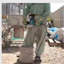
Мощный двигатель и понижающий число оборотов редуктор, увеличивают крутящий момент. D-образная рукоятка вращается на 360° для работы в разных положениях. Регулировка скорости вращения при помощи включателя. Алюминиевый корпус редуктора. Обрезиненная рукоятка.
