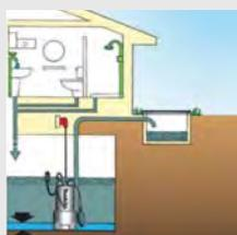
Внешний кожух обеспечивает постоянное охлаждение электродвигателя перекачиваемой жидкостью. Способен обеспечить практически полное удаление воды. Можно использовать для осушения подвалов, удаления проникшей воды, для систем садовой ирригации.
