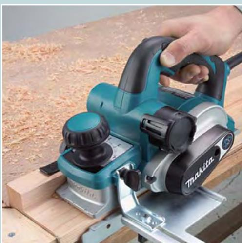
Электрорубанок прекрасно подходит для обработки древесины. Для достижения точного среза рекомендуется использовать параллельную направляющую. При работе рубанком, рекомендуется использовать пылесос, так как он обеспечивает чистоту на рабочем месте, или мешок для сбора стружки. Следует своевременно очищать пылесборник от стружки и опилок, для предотвращения засора и последующего выхода из строя системы пылеудаления рубанка.
