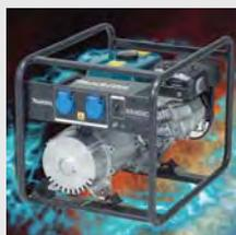
4-х тактный бензиновый двигатель ROBIN с воздушным охлаждением. Бесщёточный, самовозбуждающийся, двухполюсный, однофазный. Система стабилизации напряжения конденсаторного типа. Тип защитного устройства автоматический предохранитель. Свеча зажигания BR-6HS (NGK). Система запуска с помощью тросика.
