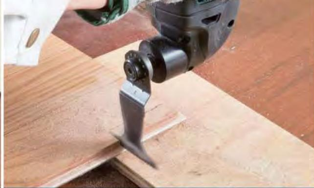
Резка дерева погружением
