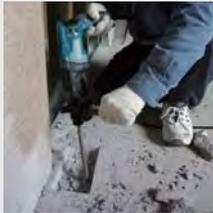
Три режима работы: сверление, сверление с ударом или долбление. Отсутствие удара на холостом ходу.
