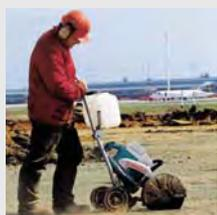
Привод аварийного отключения газа и кнопка безопасности, расположены на ручки тележки для большей безопасности пользователя. Кронштейн установки бензореза, который может сдвигаться влево и вправо для смещения линии реза, что позволяет делать рез близко к стене. Благодаря запатентованной крепежной системе Quick-Lock бензорезы с абразивными дисками фирмы Makita монтируются на направляющую тележку без помощи специальных инструментов
