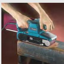
Автоматическая система регулировки положения ленты, мощный пылесборник, низкий уровень шума (85 дБ). Ровная полировка. Электронная регулировка скорости ленты.
