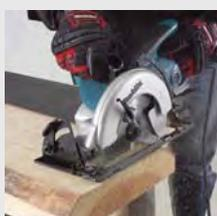
Гипоидная передача вращения от двигателя обеспечивает большую мощность и производительность. Удобная большая верхняя ручка. Кнопка блокировки шпинделя для легкой смены диска. Специальная обработка основания улучшает коррозионную стойкость.
