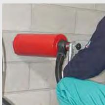
Дрель для сухого и мокрого сверления с алмазной коронкой и мощным (1700 Вт) мотором обеспечивает безударное и точное сверление поверхностей из бетона и натурального камня. Электронный ограничитель крутящего момента и устройство контроля скорости для сохранения постоянной скорости даже под нагрузкой. Оборудована механической безопасной муфтой.
