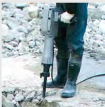
Высокая мощность для тяжёлых условий работы. Антивибрационная рукоятка. Возможность использования стандартных долот (30 мм). Система автоматического отключения щёток.
