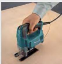
Механическая система противовеса для снижения уровня вибрации. Электронный регулятор числа оборотов двигателя позволяет выбирать оптимальную скорость резания для различных материалов. Подвижный прозрачный защитный кожух позволяет оператору от попадания стружки и пыли.
