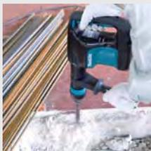
Электронная система контроля скорости вращения и "плавный пуск". Электронная регулировка количества ударов в минуту. Два световых индикатора оповещают о необходимости замены угольных щёток и о неисправности кабеля и выключателя. Продлён срок службы у автоматическими отключающихся угольных щёток, дольше чем у HM0860C. Установка долота в 12-ти положениях через 30°.
