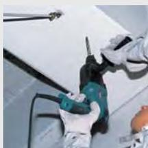
Три режима работы: сверление, сверление с ударом или долбление. Возможность установки долота в 40 положениях без дополнительных принадлежностей. Рукоятка с мягкой резиновой накладкой обеспечивает полный контроль над инструментом. Электронная регулировка числа оборотов для точного сверления + реверс.
