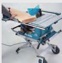
Настольная пила для очень точного реза. Мощный мотор. Алюминиевый распиловочный стол 610x620 мм, возможность удлинить стол справа на 150 мм, слева на 200 мм, спереди на 70 мм.
