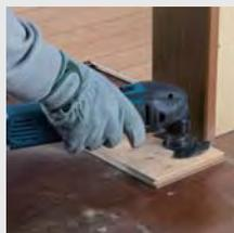
Позволяет выполнять различные виды работ, такие как: резка металла, дерева, керамической плитки, гипсокартона, пенопласта и резины; шлифовка и полирование различных материалов и т.д. Возможность установки аксессуара в 12 различных положениях через каждые 30 градусов, что позволяет работать даже в самых тесных условиях.
