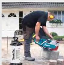
Увеличенный воздушный фильтр защищает двигатель от проникновения пыли и грязи. До 12 месяцев работы без обслуживания фильтра. Карбюратор с диафрагмой, электронное зажигание, механический стартер. Вертикальное открытие топливного бака позволяет комфортно заправлять бензорез. Смотровое окно для проверки уровня топлива. Низкая вибрация делает работу более удобной. До 20% меньше расход топлива
