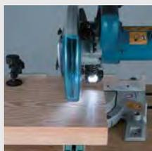
Максимальный размер распиловки: 305 мм (ширина). 2 длинных стальных направляющих, выполненных из коротких стальных стержней позволяют вести точную распиловку. Косой рез вправо (0-45°). Лазерный маркер линии разреза Easy Trace.
