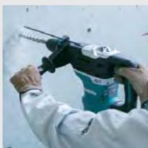
Два режима работы: сверление с ударом или долбление. Плавный пуск. Световой индикатор напоминает о необходимости замены угольных щёток. Индикатор неисправности кабеля и включателя.
