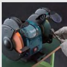
Для удобства пользователя прозрачный отражатель защищает глаза от искр и стружки.
