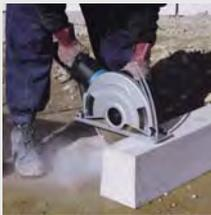
Алмазный диск (диаметр - 305 мм) обеспечивает максимальную глубину резки 100 мм. Функция плавного пуска. Мягкость и комфорт при резке. Эксклюзивная система привода с муфтой (Super Joint System™) предотвращает рывки инструмента при работе и пуске.
