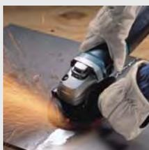
Пылезащищённый мотор высокой мощности (1200 Вт) в компактном корпусе. Специальная система привода с муфтой (Super Joint System®) предотвращает рывки инструмента при работе и пуске. Установка и снятие защитного кожуха без специального инструмента. Автоматическое отключение щётки. Лабиринтное уплотнение защищает мотор и подшипники от загрязнения.
