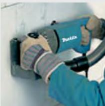
Высокая режущая способность от 8 до 43 мм по ширине и от 15 до 60 мм по глубине за один прием, делает этот инструмент вне какой либо конкуренции. Идеален для работ под разводку электропроводки и водосточных систем, а также систем отопления.
