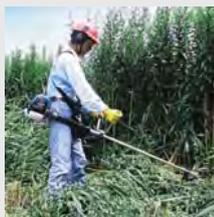
Легкая бензокоса с прямым валом. Тихий и мощный двухтактный двигатель Robin с низким уровнем токсичности выхлопных газов. Топливный насос «Праймаер» для быстрого запуска двигателя. Удобный двойной плечевой ремень. Низкий уровень вибрации. Удобная U-образная рукоятка. Режущий инструмент
