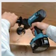
Мощная, 3-х скоростная аккумуляторная дрель-шуруповёрт. Высокая производительность благодаря мощному мотору с 3-мя скоростями для более широкого применения. Полностью металлический редуктор для увеличения износостойкости. Отдельный переключатель режимов работы на корпусе.
