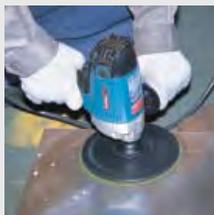
Регулировка скорости при помощи ролика. Блокировка тригерного выключателя для снижения усталости при продолжительных работах.
