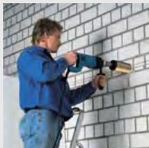
Дрель с мощным двигателем (1400 Вт) для быстрого сверления железобетонных и кирпичных конструкций. Расцепляющая муфта останавливает вращение сверла при его заклинивании. Электронный контроль скорости.
