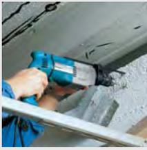
Металлический корпус редуктора, обеспечивает надёжность и длительный срок службы инструмента. Ударопрочная рукоятка со встроенным резиновым амортизатором, отлично обтекает ладонь руки.
