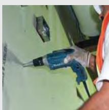
Превосходно подходит для закручивания шурупов со специальными шестигранными головками. Мощный 570 Вт мотор обеспечивает прекрасную скорость монтажа. Конструкция подшипников и литой алюминиевый корпус редуктора для трудоёмких работ. Эргономичная обрезиненная рукоятка для превосходного манипулирования шуруповёртом. Синхронизирующая муфта обеспечивает бесшумную работу. Увеличенная износостойкость зажима на пояс. Подсветка рабочей области
