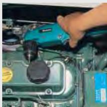
Компактная конструкция дрели позволяет использовать ее даже в очень маленьком пространстве. Быстрозажимной патрон для быстрой смены сверла.
