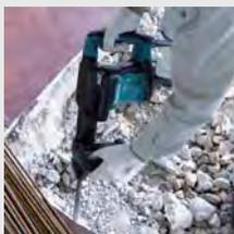
Система активного поглощения вибрации AVT, плюс антивибрационная задняя рукоятка. Электронная система контроля скорости вращения и "плавный пуск". Два световых индикатора оповещают о необходимости замены угольных щёток и о неисправности кабеля и выключателя. Отключение удара в режиме холостого хода. Продлён срок службы у автоматическими отключающихся угольных щёток, дольше чем у HM0860C. Установка долота в 12-ти положениях через 30°.
