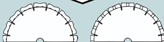
Новые и продвинутые технологии используют эффект «бутерброда» - два диска спрессовываются с центром из мягкого металла для снижения Вибрации и снижения уровня Шума. Более низкие Вибрация и Шум делают диск безопаснее и проще для использования и он может служить дольше. Он также предоставляет совершенный уровень комфорта для пользователя.
