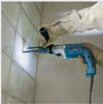
Мощный мотор (1010 Вт), узкий и компактный корпус. Два режима работы: сверление и сверление с ударом. Расцепляющая муфта останавливает вращение сверла, при его заклинивании. Новая система реверса продлевает срок службы угольных щёток, сохраняет мощность при работе в режиме реверса.
