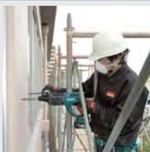
Три режима работы: Сверление, сверление с ударом, долбление. Эргономичная D-образная рукоятка для большего контроля над инструментом и меньшей усталости рук. Противоскользкая обрезиненная боковая рукоятка. Быстрая смена инструмента. Долото может устанавливаться в 40 разных положениях без дополнительного инструмента.
