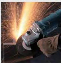
Превосходная система защиты от пыли. Усиленные конические шестерни редуктора. Увеличенная стойкость к перегреву. Поворотная задняя рукоятка может удобно устанавливаться для резки или шлифовки. Защищает обрабатываемую деталь от царапин резиновым буфером во время покоя. Возможность поворота корпуса редуктора на 90 градусов. Опорная шайба "Суперфланец" облегчает демонтаж диска после работы.
