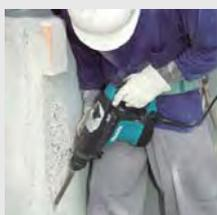
Три режима работы: сверление, сверление с ударом или долбление. Антивибрационная технология и антивибрационная задняя рукоятка - существенно снижает вибрацию перфоратора относительно HR3200C. Световой индикатор напоминает о необходимости замены угольных щёток. Индикатор неисправности кабеля и выключателя.
