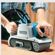
Мощный мотор (1200 Вт) для высокопроизводительной работы. Самая малюшная ленточная шлифовальная машина в своём классе (84 дБ). Скорость ленты 500 м/мин обеспечивает быстрое снятие слоя материала. Лабиринтная система, защищает мотор и подшипники от загрязнения. Удобный, поворачиваемый на 360° пылесборник.
