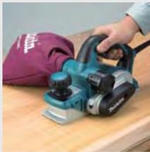
Три V-образных паза для лёгкого снятия фасок. Ручка точной регулировки глубины с шагом 0,1 мм. При каждом шаге изменения глубины строгания слышен и чувствуется щелчок. Выброс опилок налево или направо. Блокировка включения как для левой, так и для правой.
