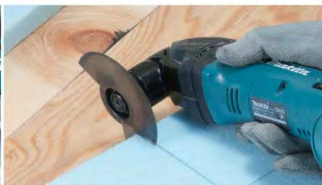
Резка пенопласта и резины
