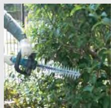
Удобная обрезиненная эргономичная ручка. Три выключателя встроены в заднюю, переднюю и нижнюю ручки. Инструмент включится только тогда, когда нажаты любые два из этих выключателей. Специальная направляющая предотвращает отскакивание инструмента. Специальное покрытие лезвий увеличивает их износостойкость и прочность.
