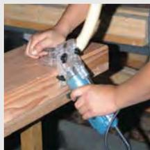
Прозрачная пластиковая основа позволяет хорошо видеть обрабатываемую деталь. Прорезиненные ручка для удобства работы оператора и лучшего контроля. Наклон базы регулируется в пределах 0-45°.
