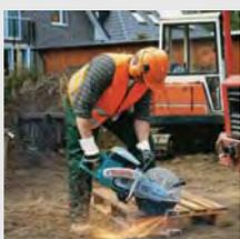
Система "двух масс" для снижения вибрации. 5-ти уровневая система фильтрации для работы в условиях сильной запылённости. Магневый кожух, изготовленный методом литья под давлением. Карбюратор: с диафрагмой, стартер: механический.
