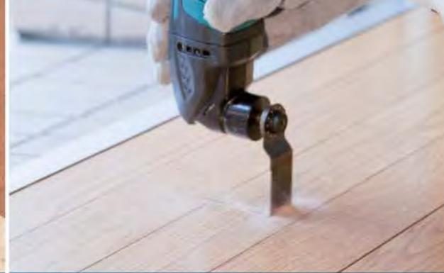
Глубокая резка дерева погружением
