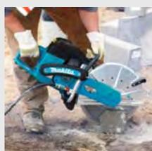
Мощный и легкий мотор объемом 81 мл позволяет работать диском с диаметром 400 мм. Оптимально расположенный центр тяжести и балансировка инструмента обеспечивает легкость и высокую маневренность в использовании. Эффективная система фильтрации воздуха. Новая демпфирующая система значительно уменьшает уровень вибрации.
