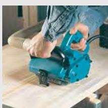
Уникальная разработка, для шлифования самых разнообразных материалов. Хорошо сбалансированный инструмент с низким расположением центра тяжести и большой передней дугообразной рукояткой. Нейлоновая шлифовальная щётка придаёт красивую текстуру древесине. Дополнительные щётки для быстрого и эффективного удаления краски и ржавчины. Возможно присоединение пылесборника.
