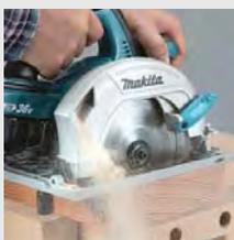
Лёгкий и компактный инструмент. Мощный мотор обеспечивает чистый и быстрый распил. Обрезиненная эргономичная рукоятка. Защитный кожух и выдвигаемые шкалы глубины и угла реза на алюминиевом основании.
