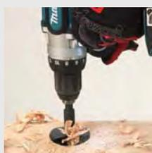
Высокая производительность инструмента благодаря большому моменту затяжки. Небольшой вес, компактный обрезиненный ударопрочный корпус. Статор с четырьмя магнитами обеспечивает высокую мощность мотора. Алюминиевый корпус редуктора. Подсветка рабочей зоны. Обрезиненная боковая рукоятка.
