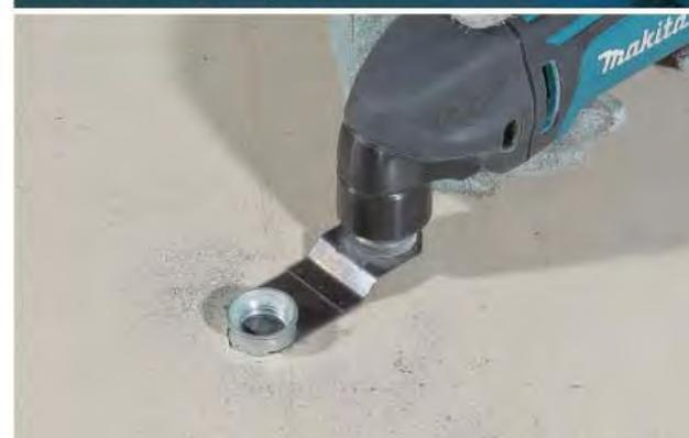
Резка металлических труб заподлицо
