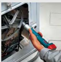
Компактность для работы в ограниченном пространстве; высота инструмента с насадкой составляет примерно 60 мм. Используя дополнительные аксессуары, шурупверт трансформируется в прямую отвертку или трёхточечный ключ. Обладает ударной системой, обеспечивающей быстрое и мощное крепление
