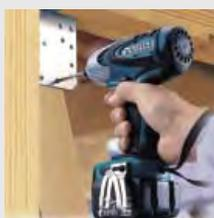
Бесшумная работа благодаря передаче импульса удара через масляный ударный механизм. Поток воздуха охлаждает масло через специально разработанную систему воздухопроводов, что способствует длительной работе инструмента. Эргономичная рукоятка
