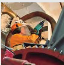
Дрель с мощным двигателем (850 Вт) для быстрого сверления железобетонных и кирпичных конструкций. Расцепляющая муфта останавливает вращение сверла при его заклинивании.
