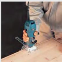
Эргономичный и удлиненный корпус обеспечивает удобный захват и снижает утомляемость оператора. Резиновый ролик для легкой и точной настройки глубины фрезерования.
