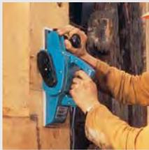
Обрабатывает поверхность шириной до 110 мм и глубиной до 2 мм за один проход. Мощный мотор (840 Вт) в лёгком и компактном корпусе (4,2 кг).
