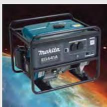
4-х тактный бензиновый двигатель ROBIN с воздушным охлаждением. Щёточный, самовозбуждающийся, двухполярный, однофазный. Автоматическая стабилизация напряжения. Направление вращения двигателя против часовой стрелки. Тип защитного устройства автоматический предохранитель. Свеча зажигания BR-6HS (NGK). Система запуска с помощью тросика.
