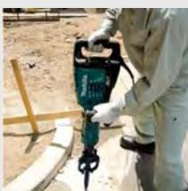
Система активного поглощения вибрации (AVT), снижает уровень вибрации на пользователя до 70%. Электронная система контроля скорости вращения и "плавный пуск". Электронная регулировка количества ударов в минуту. Два световых индикатора оповещают о необходимости замены угольных щёток и о неисправности кабеля и выключателя. Отключение удара в режиме холостого хода. Автоматически отключающиеся угольные щётки.
