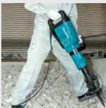
Электронная система контроля скорости вращения и "плавный пуск". Электронная регулировка количества ударов в минуту. Два световых индикатора оповещают о необходимости замены угольных щёток и о неисправности кабеля и выключателя. Продлён срок службы у автоматически отключающихся угольных щёток.
