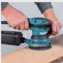
Возможность установить переднюю рукоятку в любой удобной для пользователя позиции в пределах 300° вокруг корпуса машины. Увеличенные шарикоподшипники повышают прочность и износостойкость инструмента. Возможность присоединения, как пластикового пылесборника со сменными бумажными
