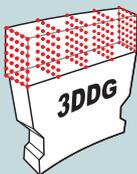
Случайное распределение алмазов означает, что каждый алмаз размещен под действием разного давления. Упорядочивание алмазов позволяет работать как одно целое, образуя единую поверхность и распределяя нагрузку. Это также означает, что алмазы изнашиваются и выпадают в одно время и поэтому использование каждого алмаза максимально.
