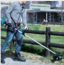
Низкий уровень шума и вибрации. Используется бесщеточный мотор, не требующий обслуживания. Функция реверса для быстрой очистки головки от травы. Индикатор низкой емкости аккумулятора. Эргономичная петлеобразная ручка.
