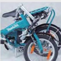
4 уровня регулировки мощности. Возможна установка одного или двух 18В Li-Ion аккумуляторов. Возможно передвигаться, как на обычном велосипеде (без аккумуляторов). Легкая алюминиевая рама. Колеса 16". Складывается для удобства транспортировки.
